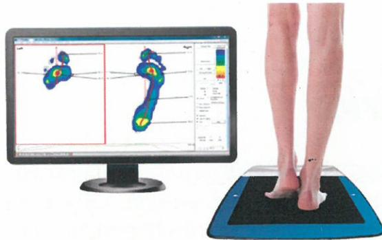
**L'esame baropodometrico può essere richiesto direttamente dal medico specialista** al fine di disporre d' informazioni quantitative, a supporto della valutazione, **ma può essere anche uno strumento utile per il tecnico ortopedico** nella progettazione di un'ortesi plantare, nonché per la verifica della sua efficacia.
